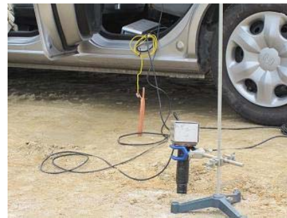
図 3 : NaI シンチレーション検出器の接続の様子
